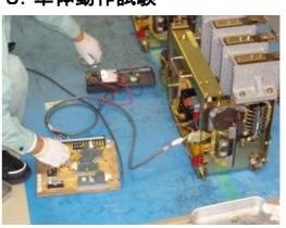
機器単体での電気的動作試験を行います。
