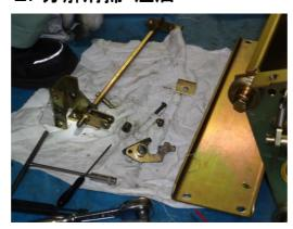
駆動箇所を分解後、古い潤滑油を ------取り除き新しい潤滑油を塗布いたします。
